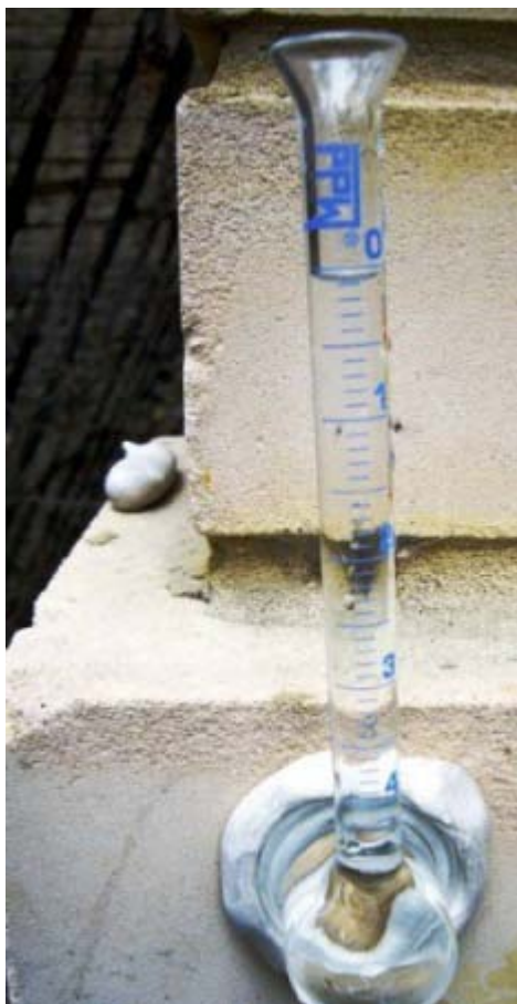
Фото 4. За 2 часа столбик воды в трубке Карстена понизился на пол деления (0,05мл).
