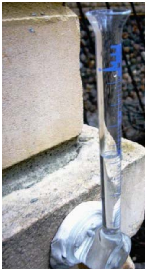
Фото 5. За два часа столбик воды в трубке Карстена понизился на 18 делений (1,8мл).
